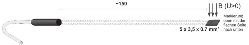
Abb. 82 Maße Transversalsonde 2000 mT (AS-NCu-Wire)
