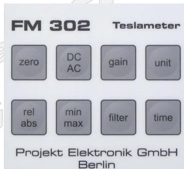
Abb. 3 Tastatur des Teslameter FM 302
