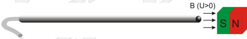
*Abb. 39 Polarität Axialsonde*
